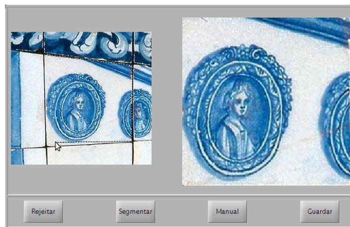
A interface do sistema pode ser observada nas figuras acima. Os azulejos são automaticamente detectados, corrigidos geométricamente e fotométricamente (homogeneizar a cor e brilho) e etiquetados numa base de dados.
